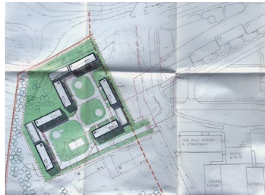
Obrázok 34 Návrh zastavovacej štúdie šiestich nízkoštandardných bytových domov na Luníku IX. Okrem bytových domov H – M sa v pláne nachádza aj rezerva pre dva ďalšie N – O. Vedľa bytových domov boli projektované prístrešky pre drevo, nakoľko sa neuvažovalo s napojením bytových domov na centrálny vykurovací systém
